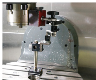
試験は工作機械に円弧運動をさせるだけ
