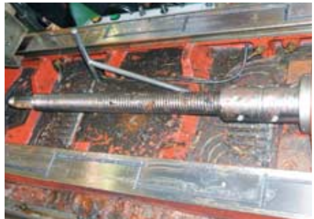
津波による浸水で錆びた、マシニングセンターのテーブル及びボールネジ
