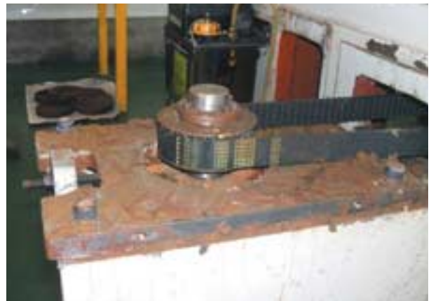
津波による浸水で腐食した工作機械
