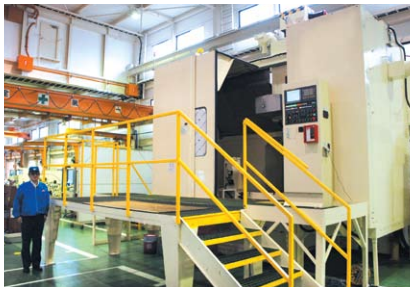
航空機関係のエンジンケース割出加工に使用される研削盤。幅7.5m、奥行10.5m、高さ5.5m
