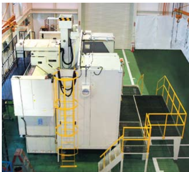
航空機関係のエンジンケース割出加工に使用される研削盤。幅7.5m、奥行10.5m、高さ5.5m
