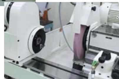
国産品よりもかなり高価ですが、世界的に評価の高い研削盤です。25年の使用を経てさすがに加工精度が低下していましたが、STUDER社は古い機械の部品も完璧に揃えており、最短3日で部品が届くなど対応も早いため、オーバーホール、部品交換によって迅速で効果的なメンテナンスが可能です。この場合の交換部品は95%メーカー(スイス)から取り寄せ、精度、外見共に新品同様にオーバーホールできました。費用は新規購入の約半分程度です。担当部署の上司の方が、戻ってきたRHU-400を見て新品と勘違いされ、「新しい機械を買つていいとはいってないぞ!」と言われたそうです。
